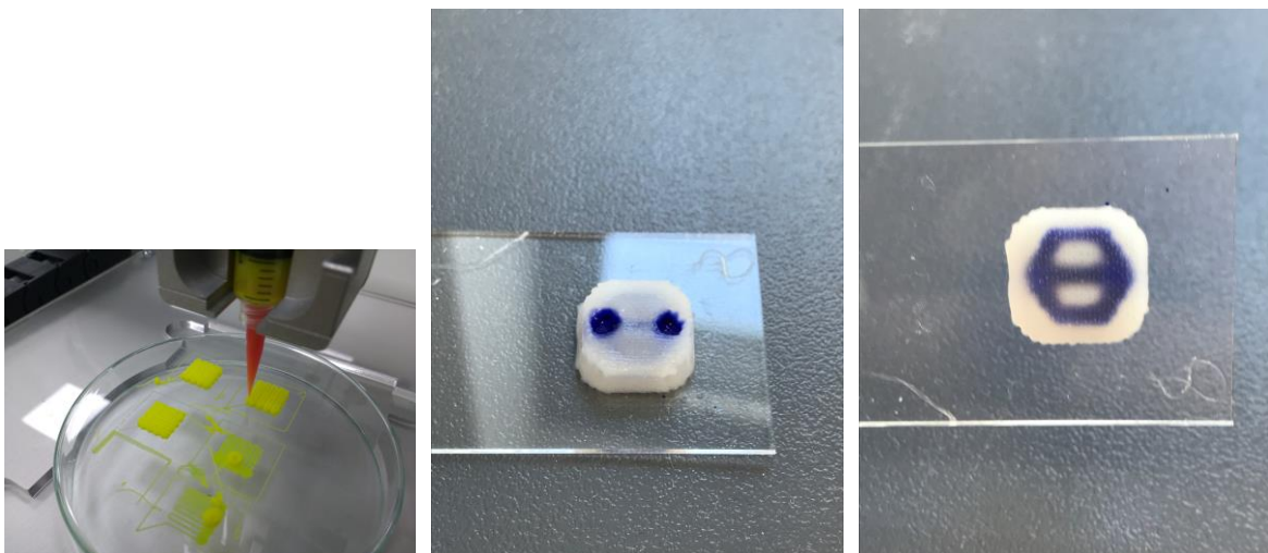
Slika 1: LEVO: (testni) izdelan nosilec, SREDINA in DESNO: primer izdelanega prototipnega nosilca z notranjim kanalčkom (za in vitro model žilja) – slikan od zgoraj in spodaj. Nosilec je napolnjen z barvilom za boljši prikaz notranjega kanalčka.
